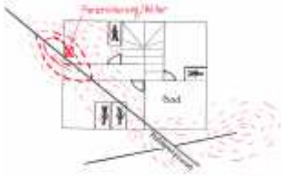
Abb. 8 Ungünstige Position der Panzersicherung erzeugt Störzone
